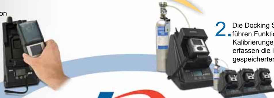
2. Die Docking Stationen führen Funktionstests und Kalibrierungen durch und erfassen die im Gerät gespeicherten Daten.
