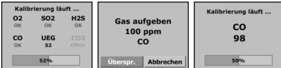
Nach Abschluss der Kalibrierung gibt die folgende Anzeige für alle sechs Sensoren das Ergebnis der Kalibrierung als bestanden (Bestnd), grenzwertig (Grnzw), übersprungen (Übrspr) oder fehlgeschlagen (Fhlgsl) an.
