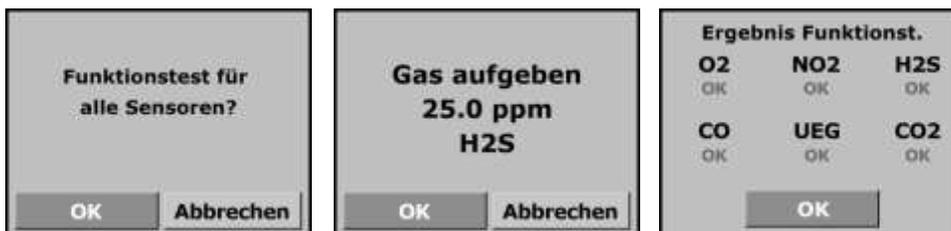
Wenn alle Sensoren den Funktionstest bestanden haben, kehrt das Gerät zur Messwertanzeige zurück. Falls ein Sensor den Funktionstest nicht bestanden hat, bietet das Gerät nach Anzeige und Quittierung der Ergebnisse die Optionen fortzufahren oder den (bzw. die) beanstandeten Sensor(en) zu kalibrieren. Wählt der Bediener „Abbrechen“, wird der Sensor nicht kalibriert, und das Gerät fährt mit dem nächsten Sensor fort. Wählt der Bediener „OK“, wird der beanstandete Sensor kalibriert.
