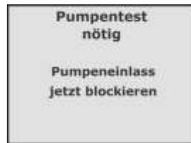
Den Pumpeneingang mit einem Finger verschließen, um den Luftstrom zu blockieren.
