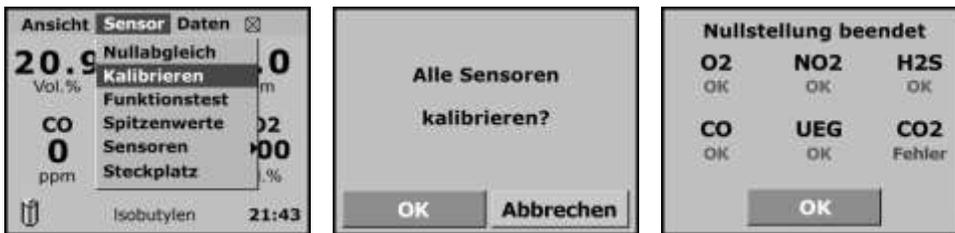
Dabei zeigt das Gerät eine Aufforderung an, Gas an das Gerät zu leiten. Die Kalibrierung beginnt, sobald der Sensor Gas misst. Der Bediener muss das Gas innerhalb von 5 Minuten zuführen, andernfalls erfolgt ein Timeout. Der Gasdurchfluss sollte 0,5 l/min betragen. Wenn der Bediener die Kalibrierung eines Sensors „überspringen“ möchte, fährt das Gerät mit dem nächsten Sensor fort. Die Option „Abbrechen“ bricht die Kalibrierung ab und führt zur Anzeige „Kal fertig“.
