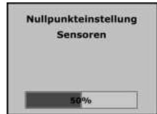
Ist das Gerät mit einem Sauerstoffsensor ausgestattet, wird dieser während des Nullens kalibriert.
