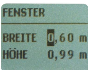
Anschließend wird das lichte Maß des Fensters in m abgefragt. Alle Berechnungen im Modul sind auf 1 FLES-BT<sup>®</sup> pro Raum ausgelegt.
