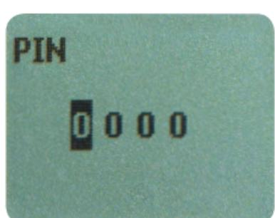
Über die ▼- und ▲-Taster haben Sie die Möglichkeit die werksseitige PIN 0000 durch eine individuelle PIN zu ersetzen. Sind alle 4 Ziffern bestätigt, so erscheint im Display
