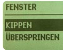
Das Fenster ist nun gleichmäßig über einen Zeitraum von 5 Sekunden zu schließen. Der Fensterhebel wird jedoch **nicht** geschlossen. Der Signalton ertönt, wenn der FLES-BT<sup>®</sup> die geschlossene Position erkannt hat und zeigt auf dem Display FENSTER GRIFF GEKIPPT.
