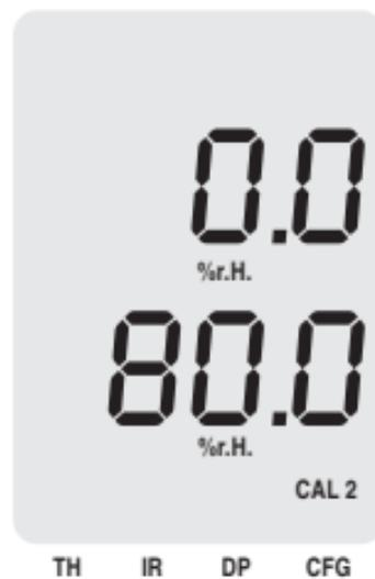
**CAL 2:** Mit CAL 2 (Einpunktkalibrierung) stellt man den Offset für Sensor 2 (relative Feuchte) ein. Der Offset dreht die Kennlinie um den unteren Abgleichpunkt (11 % r.H.). Der Abgleichpunkt muss im Bereich von 30 % bis 95 % r.H. liegen. Der Offset wird in der oberen Displayanzeige dargestellt. Maximal lassen sich  $\pm 10$  % r.H. einstellen. **CAL 2 ist nur anwählbar in Verbindung mit der Einheit % r.H. und bei einer vorherrschenden Luftfeuchte von mindestens 30 % r.H.**
