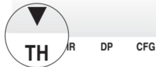
**TH:** Durch Auswahl des TH-Modus lässt sich das Gerät in der Betriebsart **Thermohygrometer** einsetzen.
