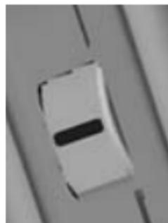
Im Gegensatz zu konventionellen Handmessgeräten besitzt das Messgerät kein Tastenfeld, sondern ein sogenanntes „**Daumen-Rad**“ auf der linken Seite des Gerätes.
