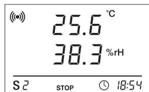
Tritt auf einem der zur Verfügung stehenden Messkanäle ein Alarm auf, erscheint neben der Messwertanzeige für diesen Kanal das Alarmsymbol, welches kontinuierlich blinkt, solange der Gutbereich verlassen wurde.
