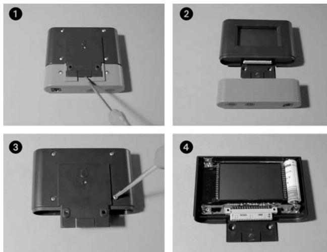
Um die Batterie wechseln zu können, trennen Sie zunächst das Display-Modul vom Sensor-Modul. Heben Sie zu diesem Zweck die Verbindungsglasche auf der Rückseite des Datenloggers mit einem geeigneten Hilfsmittel, zum Beispiel ein Schraubenzieher, vorsichtig an.
