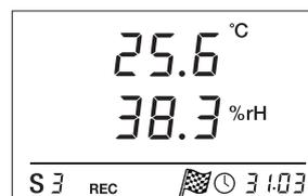
Wurde der Vorwahlbetrieb gewählt, wird in der unteren Displayzeile das Startflaggen-Symbol und in der Datum-/Uhrzeit-Anzeige im Wechsel das Startdatum und die Startzeit für die Datenaufzeichnung angezeigt.
