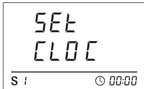
Ist die Uhrzeit gelöscht (z.B. bei einer längeren Unterbrechung) erscheint im Display „SET CLOC“ (Anmerkung: Durch die 4stellige Siebensegmentanzeige ist das Wort Clock nicht vollständig darstellbar).
