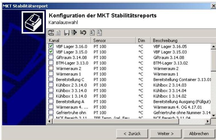
Die Liste auf dieser Seite enthält alle vorhandenen Temperaturkanäle der geladenen Datei. Wählen Sie diejenigen Kanäle durch ankreuzen aus, für die der MKT Report erstellt werden soll und klicken Sie auf die Taste "Weiter"
