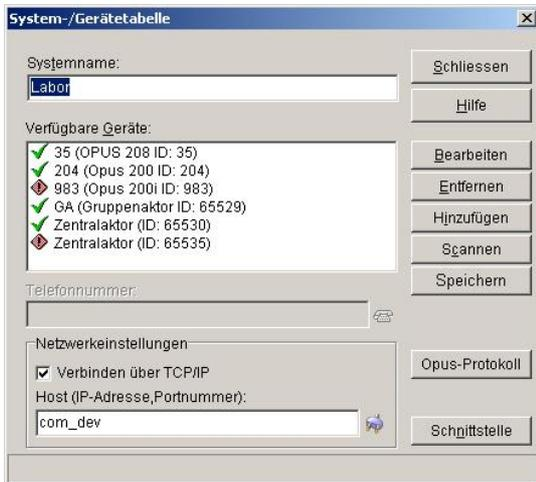
Anschließend haben Sie die Möglichkeit, überflüssige Geräte aus ihrem Mess-System zu entfernen oder noch benötigte aus dem Gerätepool im Hintergrund hinzuzufügen.
