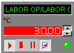
Die LED-Anzeige leuchtet im Messbetrieb grün. Sie ist weiß, wenn die Datenaufzeichnung für den Kanal unterbrochen wurde (Stop-Taste). Sie blinkt gelb, wenn durch Drücken der Pause-Taste die Aktualisierung der Anzeige unterbrochen wurde. Sie blinkt rot, wenn eine aktuelle **Grenzwertverletzung** ohne Quittierung besteht.
