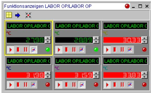
Die LED-Anzeige im Diagrammtitel leuchtet grün, wenn sich alle Kanäle im Messbetrieb befinden. Sie ist weiß, wenn die Datenaufzeichnung für einen beliebigen Kanal unterbrochen wurde (Stop-Taste). Sie blinkt gelb, wenn durch Drücken der Pause-Taste die Aktualisierung einer beliebigen Anzeige unterbrochen wurde. Sie blinkt rot, wenn eine aktuelle **Grenzwertverletzung** ohne Quittierung besteht.
