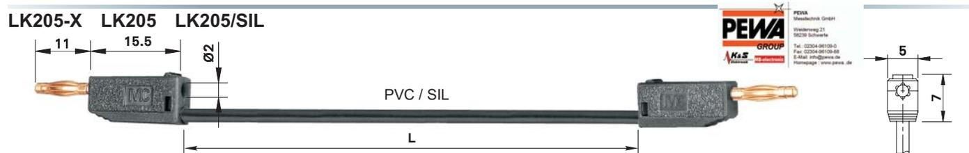
Hoch flexible Messleitungen mit PVC- oder Silicon-Isolierung, beidseitig mit stapelbarem Ø 2 mm-Lamellenstecker.
