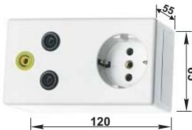
Adapter zur Kontaktierung von deutschen Netzsteckdosen. Für den Abgriff von Phase, Nullleiter und Schutzleiter hat dieser Adapter unter Beibehaltung der Netzsteckdose drei starre Ø 4 mm-Buchsen, geeignet zur Aufnahme federnder Ø 4 mm-Stecker mit starrer Isolierhülse. Nur für den deutschen Markt geeignet.
