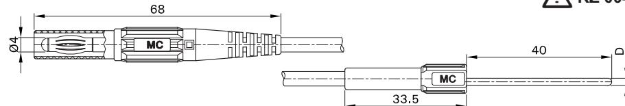
Hoch flexible Zählerprüfleitungen speziell für den Schraubanschluss an Zählerklemmen. Eine Seite starrer Rundstift aus Messing, andere Seite Ø 4 mm Lamellenstecker mit starrer Isolierhülse. Ausführungen mit verschiedenen Stiftdurchmessern D erhältlich.
