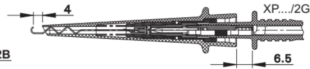
Grippe-fils à crochet rigide. Les éléments saisis sont plaqués sous la contrainte d'un ressort contre la tête isolante. Avec taraudage pour le montage sur les pointes équipant les cordons XP..../2G.
