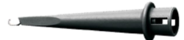
Hakenklemme mit starrem Drahtanschlusshaken. Erfasste Objekte werden unter Federdruck an den Isolierkopf herangedrückt. Innengewinde zum Aufschrauben auf die Prüfspitzen der Messleitungen XP..../2G.
