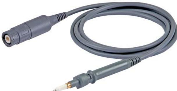
Sicherheits-Hochfrequenz-Tastkopf 10:1 in kompakter Baufom. Großer Frequenzbereich und niedrige Eingangskapazität. Hoch flexible, PVC-isolierte koaxiale Anschlussleitung mit BNC-Stecker mit integrierter Kompen-sationseinheit. Anschlussmöglichkeit für Referenzleitung am Vorderteil des Tastkopfes.
