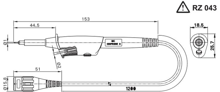
Sicherheits-Hochfrequenz-Tastkopf 100:1 für die sichere Erfassung hoher Spannungen. Mit hoch flexibler, PVC-isolierter koaxialer Anschlussleitung mit BNC-Stecker. Einstellschraube für Kompensationsabgleich und Ø 2 mm-Sicherheitsbuchse für Referenzanschluss im Griffteil. Durch geringe Eingangskapazität und grossen Eingangswiderstand ist dieser Tastkopf besonders geeignet für Messungen an empfindlichen Schaltkreisen.
