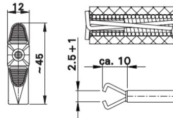
Grippe-fils à fils élastiques auto-serrants en acier spécial, permettant de saisir des broches et des fils difficilement accessibles (en retrait). Particulièrement adapté à des mesures de tension. Les fils sont guidés dans un fourreau en silicone, qui offre une excellente résistance à la chaleur et une bonne souplesse, même à de faibles températures. Equipé, dans la zone de préhension d'une douille rigide Ø 4 mm, adaptée à la connexion de fiches Ø 4 mm élastiques à fourreau rigide.
