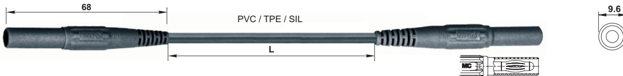
Hoch flexible Messleitungen mit PVC-, TPE oder Silicon-Isolierung, beidseitig mit axialer Ø 4 mm-Lamellenstecker mit starrer Isolierhülse. Durch den sehr hohen Isolationswiderstand der TPE-Isolierung eignet sich die Messleitung XMT-414 hervorragend für hochohmige Widerstandsmessungen.
