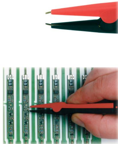
Prüfpinze für feinste Mess- und Prüfarbeiten. Kontakte aus vergoldetem Hartkupfer. Für den Anschluss konfektioniert mit hoch flexiblem, Silikon-isoliertem Zwillingskabel mit Ø 4 mm-Lammellensteckern mit starrer Isolierhülse (Stecker axial oder 90° abgewinkelt). Die gegeneinander isolierten Kontakte der Prüfpinze ermöglichen den Abgriff an zwei Messpunkten unterschiedlichen Potenzials. Pinze mit Griffbereichsmarkierung für abrutschsichere Handhabung. Exakte Kontakttschenkelführung.
