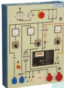
für kleine Elektrowerkstätten und vornehmlich zur Prüfung von Wechselstrom-Betriebsmitteln. Mit automatischen Gerätetestern zur Prüfung nach DIN VDE 0701-0702. Entspricht bezüglich ihrer Ausrüstung und Prüfmöglichkeiten den Mindestanforderungen des Bundesinstallateurausschusses für die Grundausstattung einer Elektrowerkstatt.
