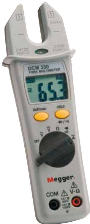
Die Gabel-Stromzange DCM330 ist ein universelles, kompaktes Messgerät für Wechselströme von 0,1 A bis 200 A und einem Digital- Multimeter mit allen Grundfunktionen. Es bietet Ihnen Spannungsmessungen bis zu 1000 V AC und DC, Widerstandsmessungen bis zu 20 M $\Omega$ , eine berührungslose Wechselspannungs-Erkennung und einen Durchgangsprüfung mit Diodenprüfung. Alle Messfunktionen haben automatische Messbereichswahl, um Messwerte einzufrieren hat das Gerät eine Data-Hold Funktion.
