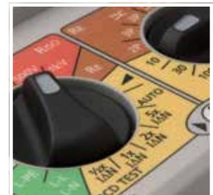
Robuste Drehschalter mit sicherer und verständlicher Farbcodierung
