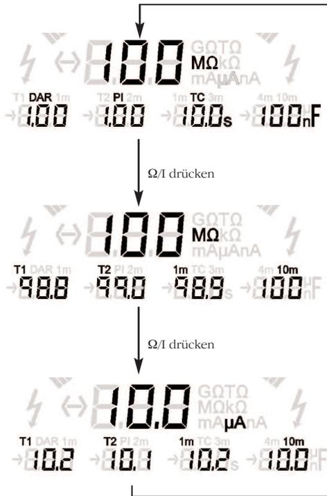
**Abbildung 2 - Das Ergebnis der Polaritätsindexprüfung (PI)**
