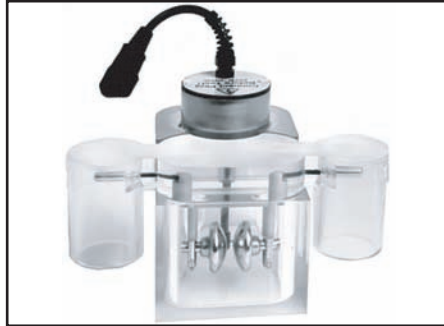
Figure 35. Cuve d'essai d'huile pour la spécification ASTM D1816
