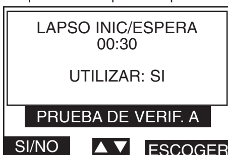
Figura 82. Pantalla de visualización de la selección de lapso inicial de espera de la prueba de verificación.
