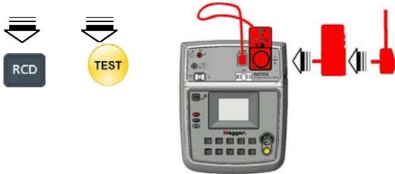
Stecken Sie den RCD / FI in die 230 V Prüfsteckdose
