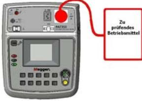
(1) Kontaktieren Sie mit der Prüfleitung alle berührbaren Metallteile des Betriebsmittels
