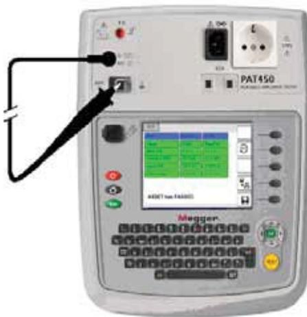
4) Drücken Sie die TEST Taste. PAT400 zeigt den Widerstand der Prüfleitung als NULL-Abgleich Wert und zeigt das Symbol
