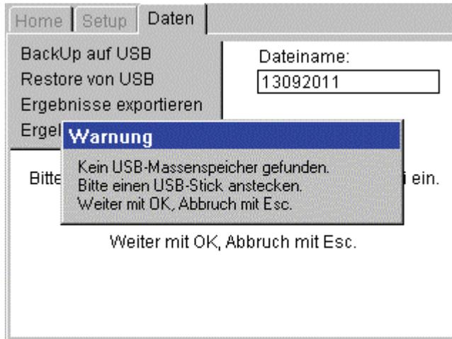
Dieser Fehler kann durch einen defekten USB-Stick hervorgerufen werden. Verwenden Sie eine andere Type und wiederholen Sie den Vorgang.
