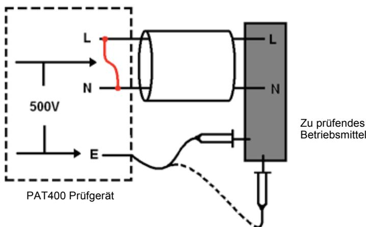
**Mit dem Tastkopf werden alle berührbaren Metallteile des zu prüfenden Betriebsmittels kontaktiert, um sicher zu stellen, dass sie keine Verbindung zur Netzversorgung haben.**
