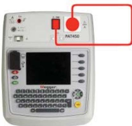
1) Stecken Sie den Netzstecker des zu prüfenden Netzkabels in die 230 V Netzprüfsteckdose am PAT400.
