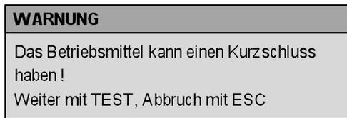
Nur wenn der Anwender sicher ist, dass das Betriebsmittel keinen Kurzschluss aufweist, darf die TEST-Taste gedrückt werden, ansonsten muss die Prüfung mit ESC abgebrochen werden
