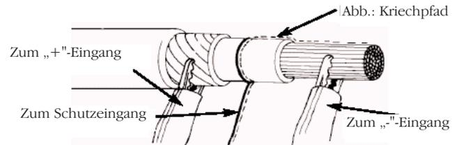
Der Schutzzeingang hat das gleiche Potenzial wie der negative Eingang. Da der Kriechstromwiderstand effektiv parallel zu dem zu messenden Widerstand vorliegt, führt der Einsatz des Schutzzeingangs dazu, dass der über die Oberflächenkriechpfade fließende Strom vom Messstromkreis weggelenkt wird. Das Gerät misst daher den Kriechstrom des Isolators und ignoriert den Kriechstrom über seine Oberfläche.
