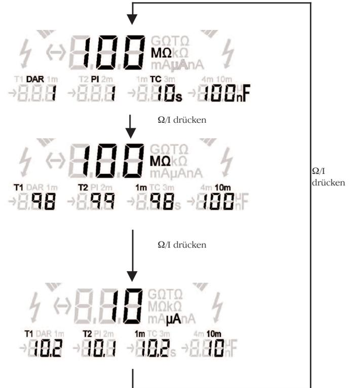
**Abbildung 1 - Das Ergebnis der Isolationswiderstandsprüfung (IR)**
