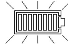
Wenn das Gerät mit Netzspannung betrieben ist, zeigt die Anzeige, dass die Batterie geladen wird, indem die Segmente des Balkensymbols animiert werden.
