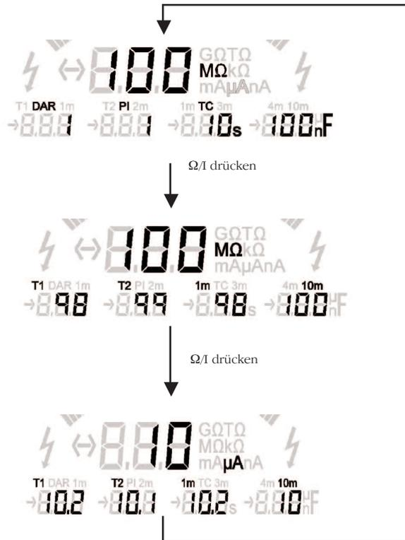
**Abbildung 2 - Das Ergebnis der Polaritätsindexprüfung (PI)**
