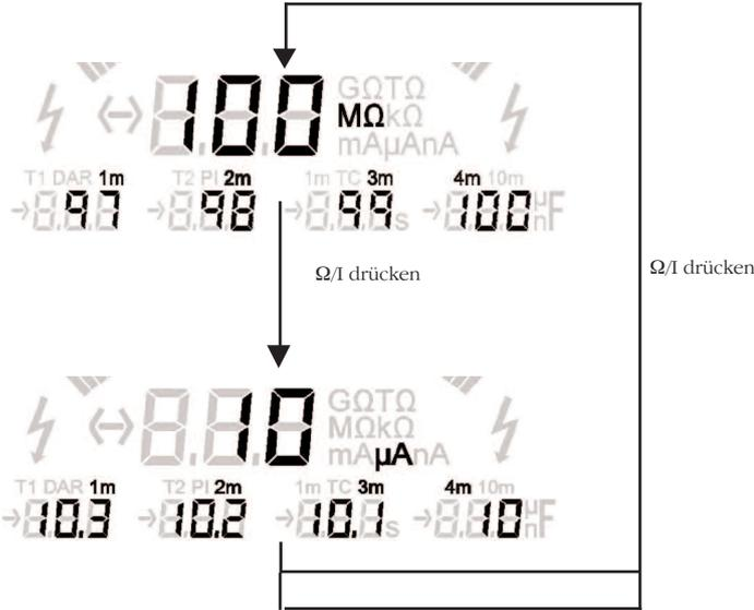
**Abbildung 4 - Das Ergebnis einer Stufenspannungsprüfung (SV)**
