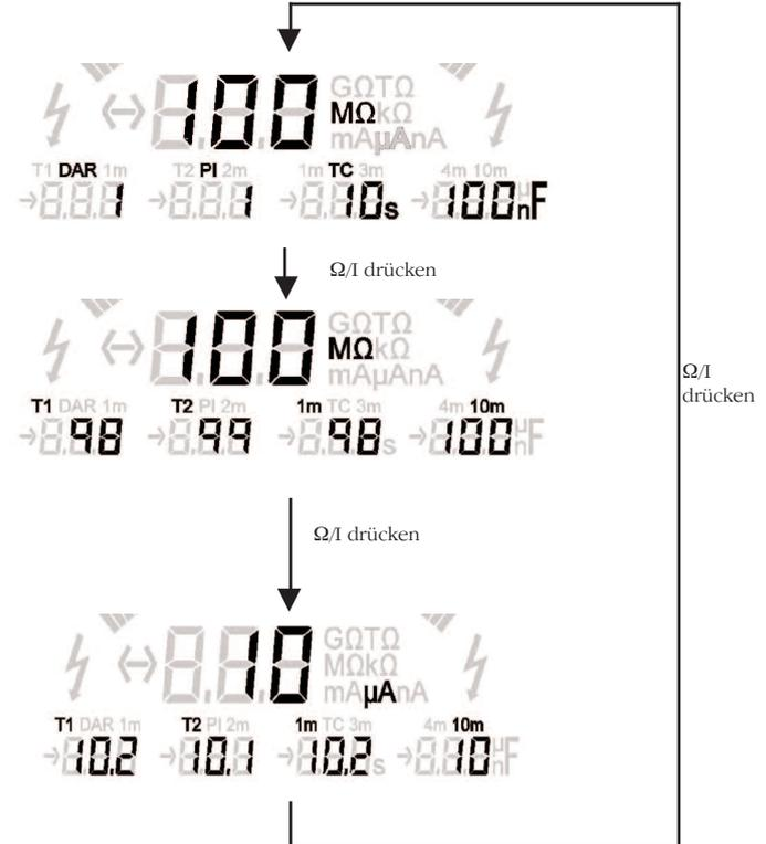
**Abbildung 3 - Das Ergebnis der dielektrischen Entladungsprüfung (DD)**
