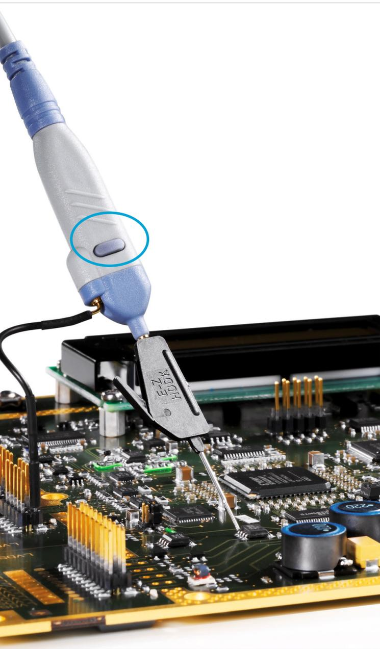
Praxisgerecht ausgelegt: Mikrotaster zum komfortablen Steuern des Geräts. Vielfältige Messspitzen und Massekabel sind bereits im Standardlieferumfang enthalten.
