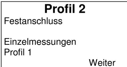
Das Profil „**Festanschluss**“ heißt, dass der Prüfling fest am Netz angeschlossen ist und nicht in das Prüfgerät gesteckt werden kann. Die Schutzleitermessung wird durchgeführt, indem die Verbindung des Schutzleiterschlusses des Prüfgerätes über die Verteilung, das Anschlusskabel des Prüflings bis zum Gehäuse des Prüflings gemessen wird.
