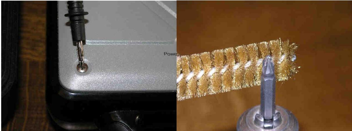
**Messung an berührbaren Teilen, die nicht mit PE verbunden sind:** Mit Sonde diese Teile abtasten. Bei sich bewegenden Teilen, wie dem Bohrer, das Futter im Betriebszustand drehend abtasten, am besten mit der optionalen Bürstensonde. Sichtschutz beachten.
