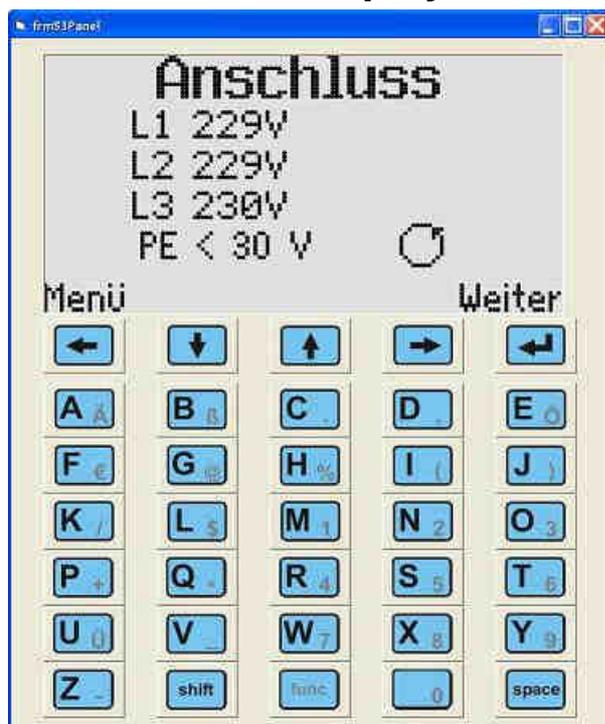
Im ersten Menü „Anschluss“ werden die vorhandenen Netzspannungen L1, L2, L3, das Drehfeld sowie die Qualität des N- und PE-Leiteranschlusses angezeigt.
