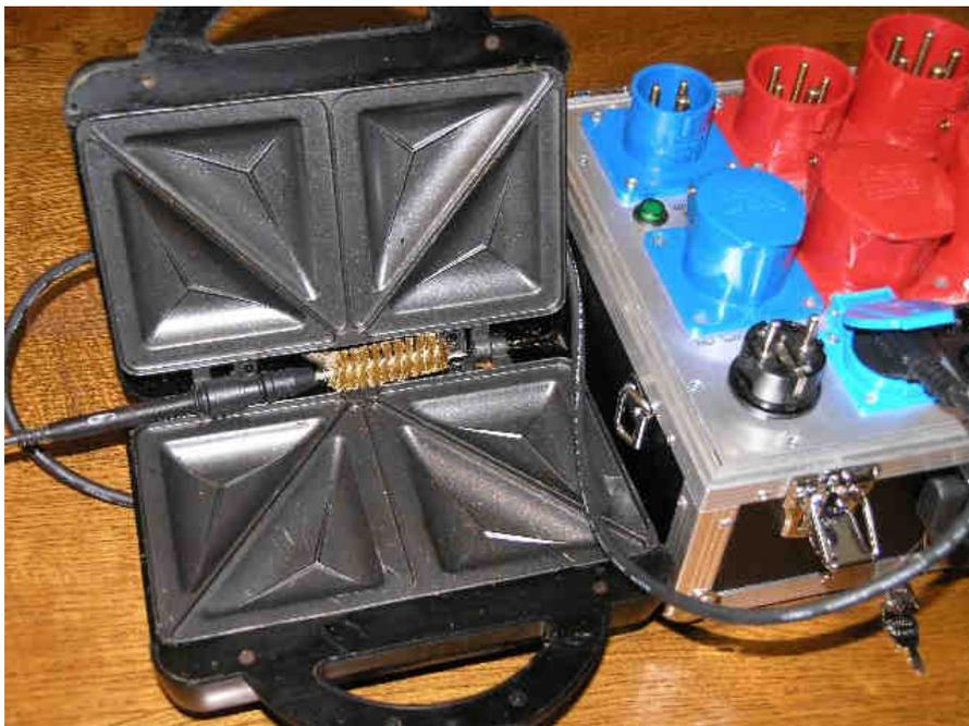
**Schutzleitermessung:** Mit Sonde Gehäuseteile abtasten
