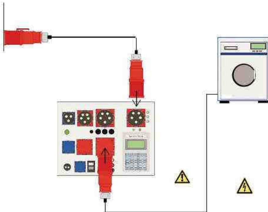
**Isolationswiderstandsmessung LN-PE, Ersatzableitstrommessung:** Gerät in Prüfdose einstecken. Gerät einschalten. Die Messung wird im spannungslosen Zustand durchgeführt.
