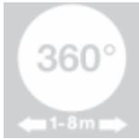
Der Erfassungswinkel beträgt 360°. Die Reichweite lässt sich stufenlos von Ø 1 bis 8 m einstellen.
