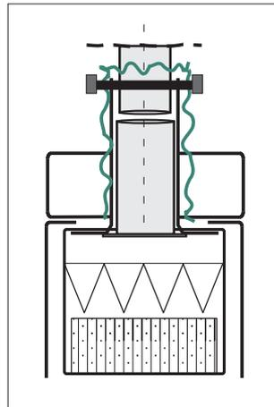
Skizze 1. Filterkassette mit Saugrohr und integriertem Schutzschlauch
