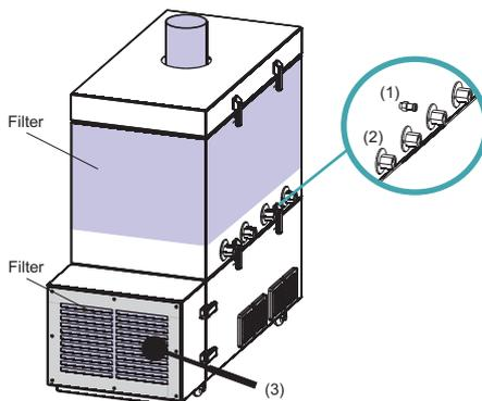
**Skizze 4. Integrierte Produktmerkmale zur Qualifizierung der Anlage im Fertigungsbereich (1 – Überdruckmessung auf Dichtigkeit, 2 – Qualifizierungsmessung nach dem Hauptfilter,**
