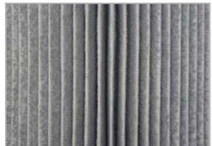
*Filterpatrone nach Abreinigung*
