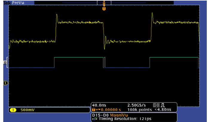
Die hochauflösende MagniVu-Aufzeichnung bietet eine zeitliche Auflösung von 121,2 ps und ermöglicht dadurch kritische Timing-Messungen an den digitalen Signalen.
