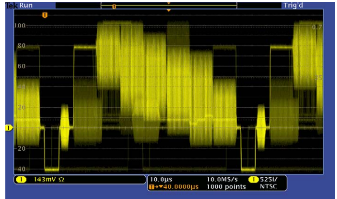
Anzeigen von NTSC-Videosignalen. Beachten Sie die Intensitätsabstufungen in der Anzeige, die durch die Fähigkeit des DPO-Moduls erzielt wird, Zeit, Amplitude und Verteilung der Amplitude im Zeitverlauf darzustellen.
