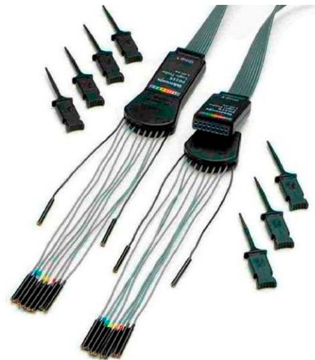
Der MSO-Tastkopf P6316 bietet zwei Kopfstecker mit jeweils acht Kanälen für den einfacheren Anschluss an Ihre Schaltung.
