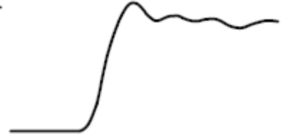
Signal mit einem langen Erdungsleiter
