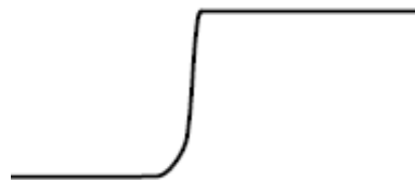
Signal mit einem kurzen Erdungsleiter
