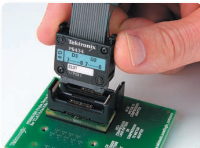
► Abbildung 5. Logikanalysator-Tastkopf mit hoher Dichte und mehreren Kanälen.
