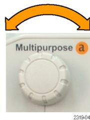
Drehen Sie dann den Mehrfunktions-Drehknopf **b**, um den Spannungspegel zu definieren, der vom Oszilloskop als Grenzwert verwendet wird, oberhalb dessen das Oszilloskop ein Signal als logisch hoch und unterhalb dessen es ein Signal als logisch niedrig behandelt.
