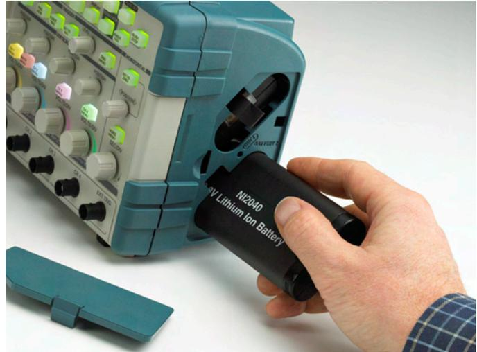
Mit den Akkus, die im laufenden Betrieb gewechselt werden können (Hot-Swap), sind Sie nahezu völlig unabhängig von einer externen Stromversorgung.
