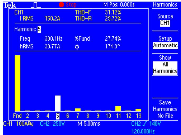
Durchführen von Oberwellenverzerrungsmessungen mit der Software TPS2PWR1.
