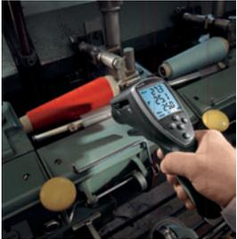
...für sich in Bewegung befindliche Teile, z. B. lagerlaufende Papierbahnen, drehende Reifen, laufende Blechbahnen etc.
