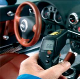
...bei schlechten Wärmeleitern, wie Keramik, Gummi, Kunststoffen etc. Ein Fühler für kontaktbehaftete Messung kann nur die richtige Temperatur anzeigen, wenn er die Temperatur des Messkörpers annehmen kann. Bei schlechten Wärmeleitern ist dies meist nicht der Fall bzw. sind die Einstellzeiten sehr lang.
