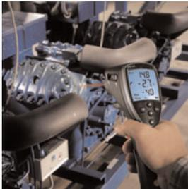
...für die Bestimmung der Oberflächentemperatur von Getrieben, Gehäusen und Lagern von kleinen und großen Motoren.
