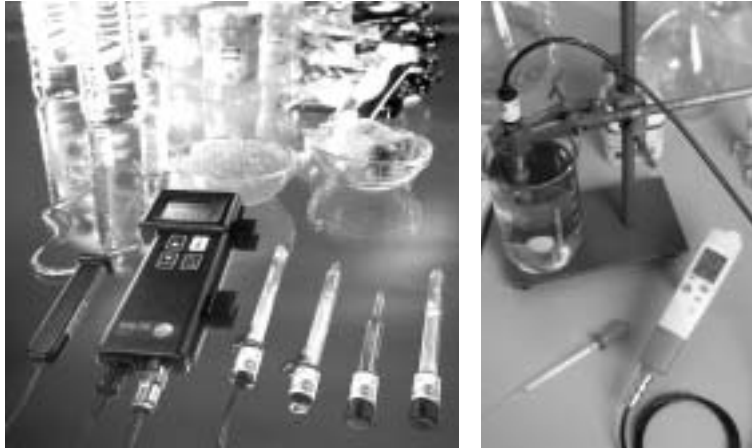
Bild 3: Beispiel eines pH-Mess-Systems mit separaten Messfühlern (testo 230 mit pH-Sonde und Edelstahl-Temperaturfühler und testo 206-pH3).
