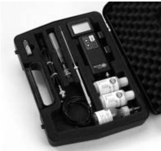
Bild 30: testo 230 – Setzusammenstellung (pH-Set 2)
