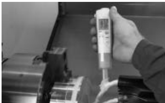
Bild 25: Bestimmung des pH-Wertes der Schmier- und Kühlmembran in einer Dreherei
