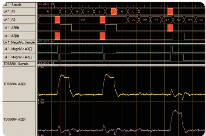
► **Abbildung 8.** Übersprecheffekte können mit Hilfe von zeitkorrelierten digitalen und analogen Signalen auf demselben Bildschirm schnell ermittelt werden.
