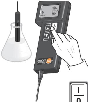
Bei älteren Meßzellen oder bei Meßzellen mit unbekannter Konstante ist es notwendig diesen Wert mittels einer Prüflösung, mit bekannter Leitfähigkeit, zu ermitteln.
