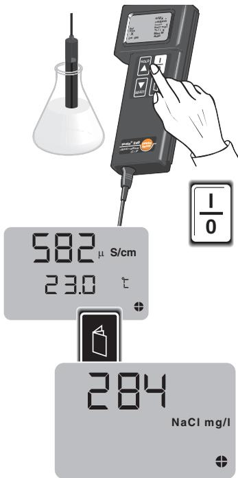
Schließen Sie die LF-Meßzelle an das Gerät an.
