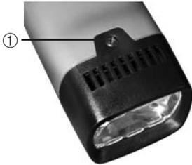
**E1:** Vordere Abdeckung ist nicht korrekt befestigt. Wenn die Meldung E1 angezeigt wird, muss das Gerät abgeschaltet werden. Lösen Sie die vordere Abdeckungsschraube (1), positionieren Sie den Reflektor neu und schrauben Sie die vordere Abdeckungsschraube wieder an.
