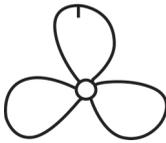
Um die Ist-Drehzahl des Ventilators bestimmen zu können, wird ein Ventilatorblatt mit einer Markierung versehen und der Test erneut durchgeführt.
