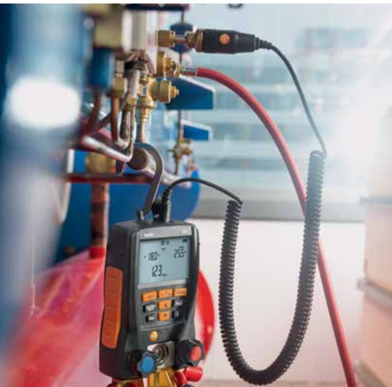
Hochpräzise Vakuummessung: testo 557 mit externer Sonde.
