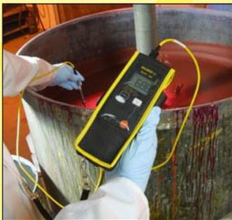
Temperaturmessung im explosionsgefährdeten Bereich
