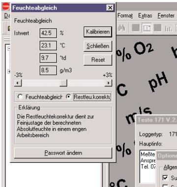
Das zweite Fenster (zu aktivieren durch setzen des Buttons auf Restfeuchtekorrektur) unter **FEUCHTE-ABGLEICH** stellt keine Alternative zum Abgleich dar, sondern bietet die Möglichkeit, bei korrekten Daten an den Abgleichpunkten (11,3 bzw. 75,3 %rF  $\pm$  2 %rF) die Kennlinie in einem engen Arbeitsbereich parallel zu verschieben um z. B. die berechneten Werte (Taupunkt und Absolutfeuchte) mit einem Referenzgerät zur Deckung zu bringen.
