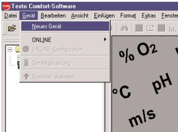
Unter **GERÄT** / "NEUES GERÄT" den Gerätetreiber für die Datenlogger der Serie testostor 171 aktivieren und Schaltsymbol "Weiter" anklicken.
