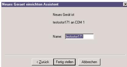
Wenn in Bild 4 kein anderer Name eingegeben worden ist erscheint bei erfolgreicher Kommunikation Bild 5 mit einem neu angelegten Gerätesymbol testostor 171 + Seriennummer.
