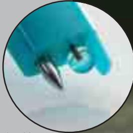
pH1-Sondenkopf für flüssige Medien, durch Ringspalt (Diaphragma) verschmutzungsunempfindlich und auslaufsicher (Gelelektrolyt)
