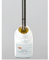
Zur schnellen und einfachen Geräteprüfung empfehlen wir Ihnen die Durchführung eines Genauigkeitstests laut der Bedienungsanleitung. Bei Wechsel der Ölart oder des Öllieferanten muss der Referenzwert neu bestimmt werden.
