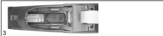
5. Entnehmen Sie den Akku aus dem Gerät und legen Sie einen neuen Akku ein. Verwenden Sie nur den Testo-Akku 0515 0107!
