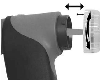
Filterkammer kann Kondensat enthalten.
