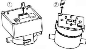
Nur CO-Messzelle: Kurzschlussbügel entfernen (① 0390 0095, ② 0390 0109).
