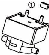
Nur CO-Messzelle: Kurzschlussbügel ① entfernen.
