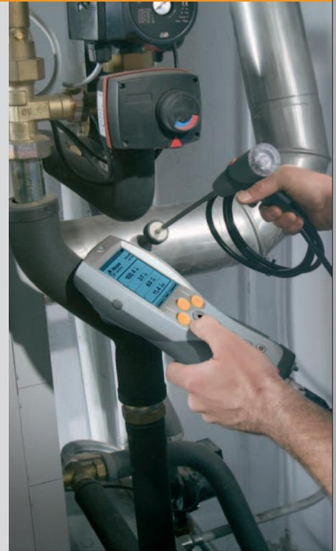
Abgasmessung an einem Brenner
