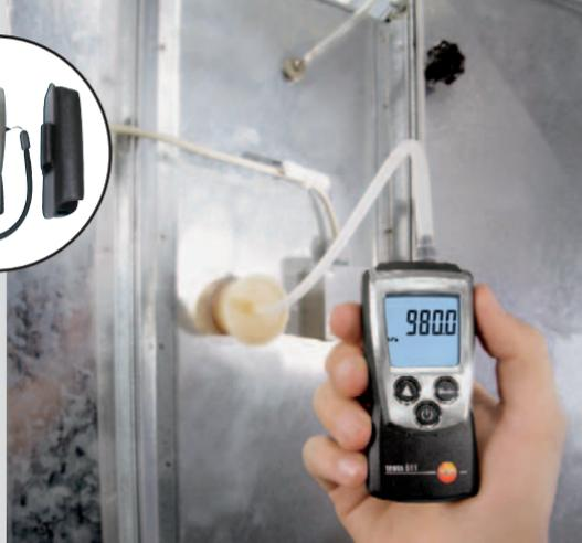
Absolutdruck-Messung zur Ermittlung der Absolutdruck-Kompensation bei der Strömungsmessung mit Staurohr
