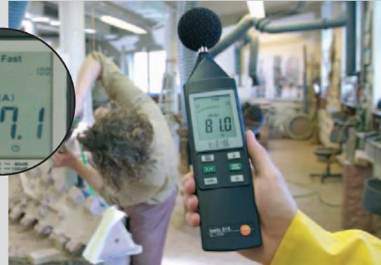
testo 816, Überprüfung der Lärmschutzbestimmung
