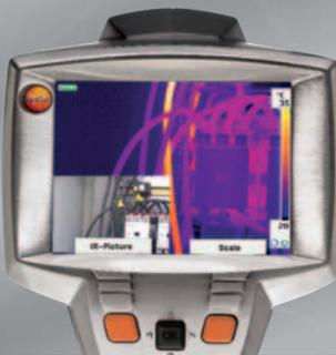
Bild-in-Bild-Funktion zur leichteren Orientierung und einfachen Dokumentation
